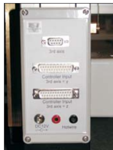
T Prikjučna kutija za kontrolu topline žice i rotacione ploče
